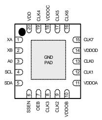
Figure 19. Si5351A 20-QFN Top View
