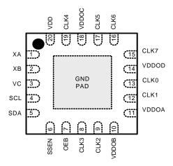
Figure 20. Si5351B 20-QFN Top View\*
