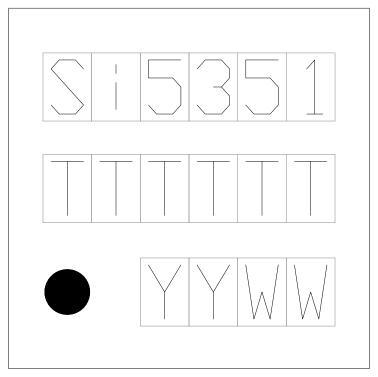
Figure 28. 20-Pin QFN Top Marking
