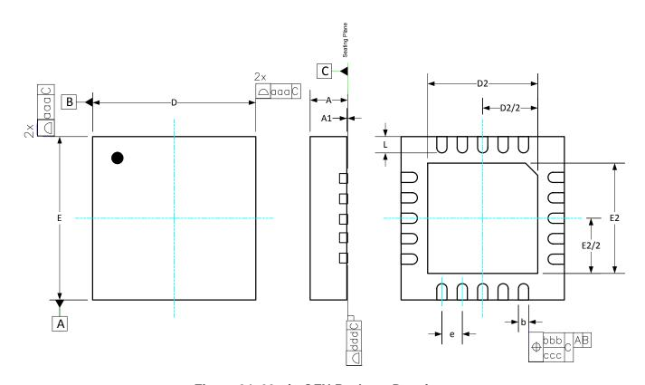
Figure 24. 20-pin QFN Package Drawing
