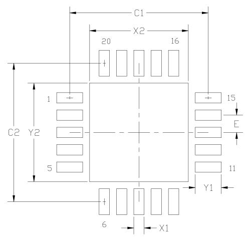
Figure 25. 20-Pin QFN Land Pattern
